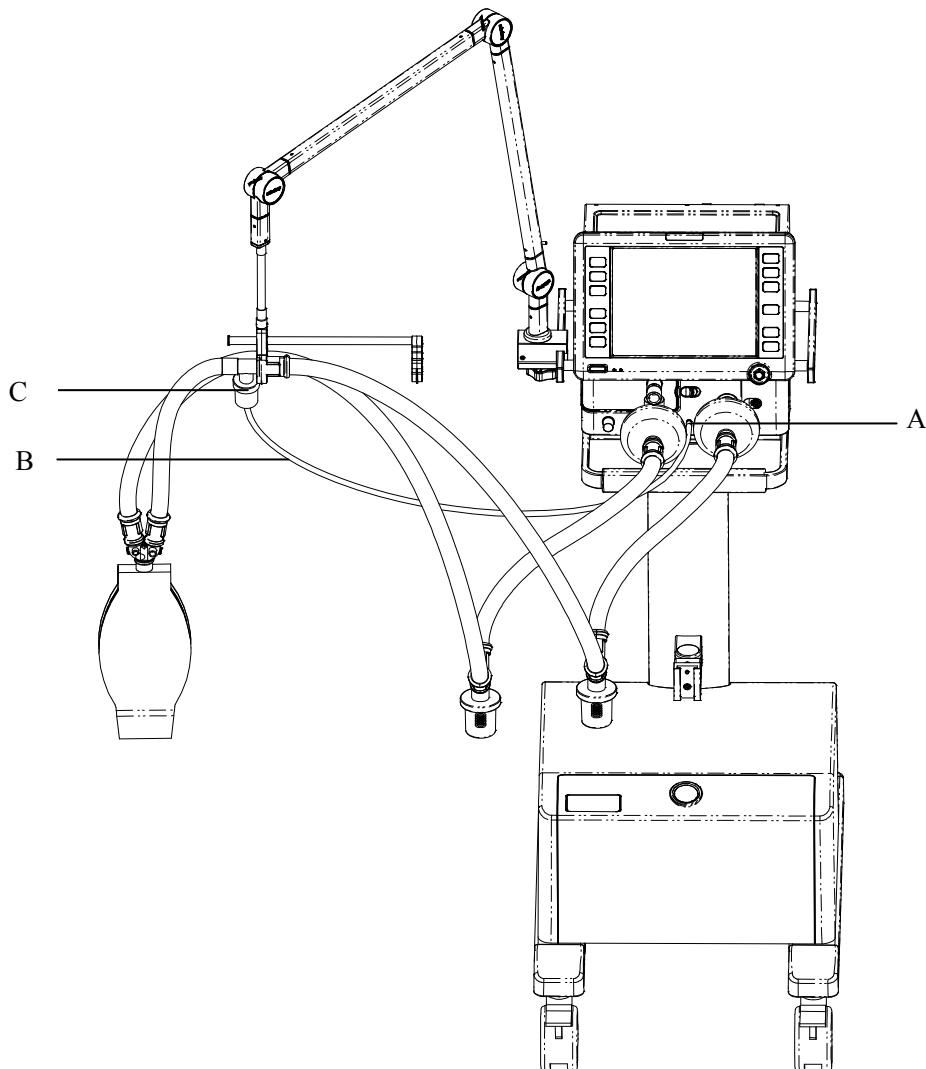
A. Соединитель ингалятора    B. Шланг ингалятора    C. Ингалятор
