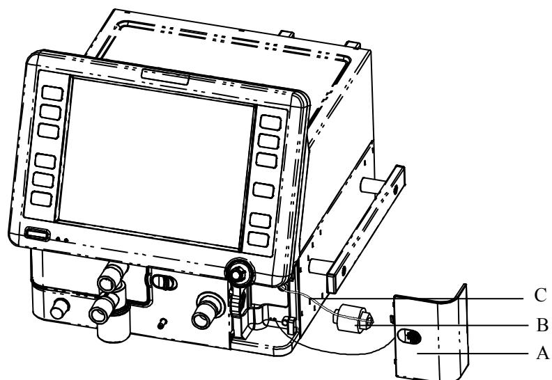
A. Крышка датчика O<sub>2</sub>      B. Датчик O<sub>2</sub>      C. Соединительная линия датчика O<sub>2</sub>
