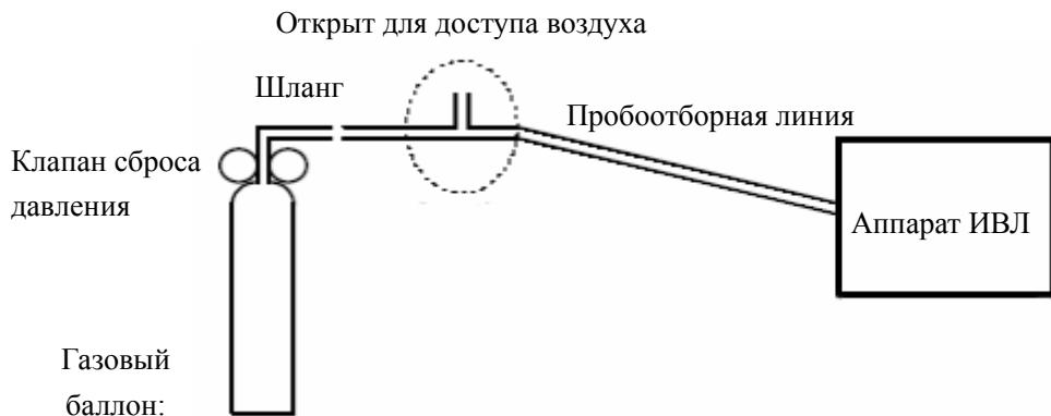
4. Подайте в пробоотб.линию CO2, открыв предохранительный клапан баллона
