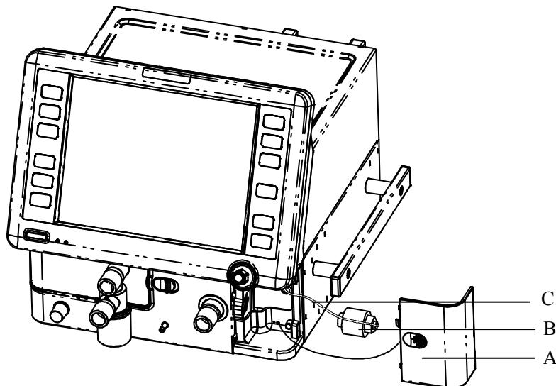
A. Крышка датчика O2    B. Датчик O2    C. Соединительная линия датчика O2
