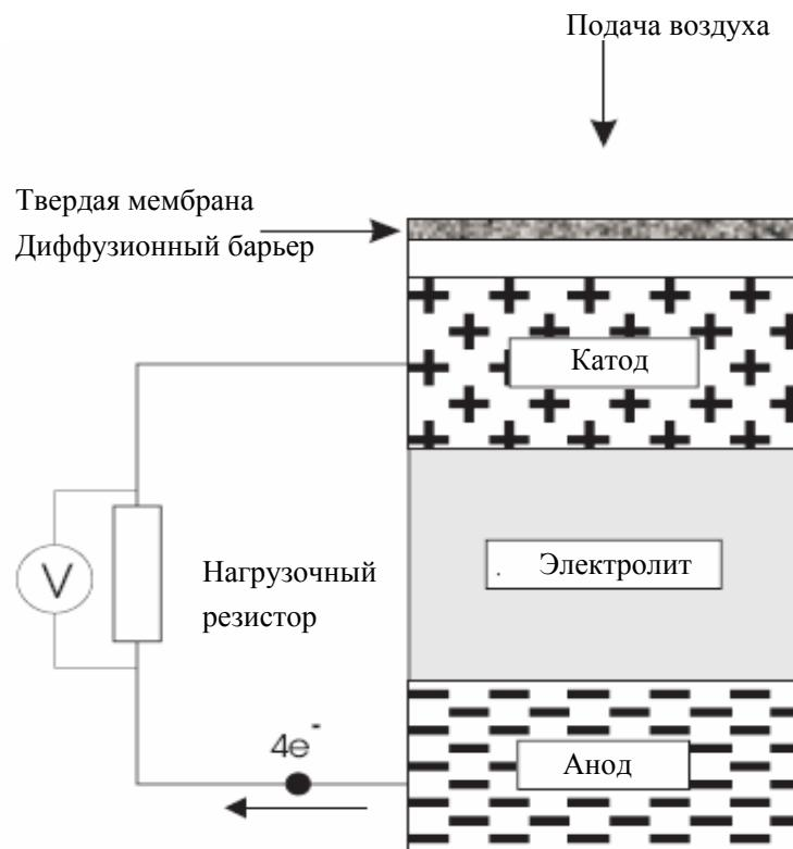
На катоде кислород распадается на гидроксильные ионы согласно следующей формуле:
