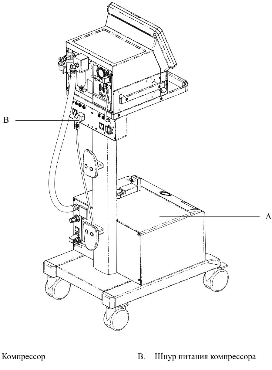
Вставьте шнур питания компрессора в дополнительный электрический выход специально для компрессора.
